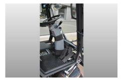
Die leichtgängige Lenkung mit in Höhe und Neigung verstellbarer Lenksäule, ein Tempomat, minimale Pedalkräfte, ein Gesundheitsfahrersitz sowie Bedien- und Kontrollinstrumente in optimalem Griffbereich runden die Leistungsmerkmale eines modernen, ergonomischen Arbeitsplatzes ab.
