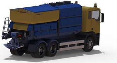
Für Flughäfen die in jeder Situation eine optimal angepasste Glättebekämpfung haben möchten, ist das intelligente ACE-2S Konzept eine gute Einstiegsvariante. Mit den Spezialstreutellern können sowohl Streu- als auch Sprühmittel ausgebracht werden.
