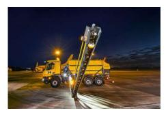
Die solide Parallelogrammkonstruktion vorne an der Maschine sorgt für eine sichere Führung der Sprüharme. Die äusseren Sprüharmsektionen aus Aluminium haben einen Kollisionsschutz mittels eines Ausbrechsystem.
