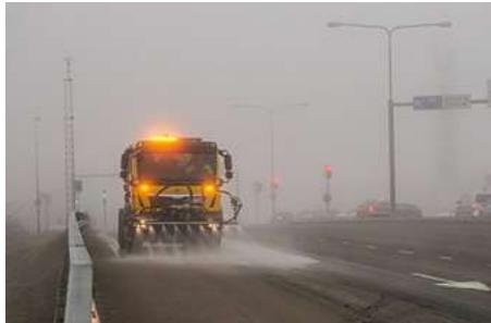
Шланг на катушке наматывания с электроприводом и все форсунки поливомоечных систем SCW размещаются на передней моющей головке, которая монтируется как фронтальное навесное оборудование на базовом шасси без необходимости использования дополнительных подъемных устройств. Моющая головка оборудована собственным подъемным механизмом для регулировки рабочей ширины и силы воздействия струй воды на дорожную поверхность.
