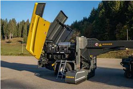
Il motore di trazione aziona le pompe idrauliche per il funzionamento e il controllo dell'unità di spazzamento e dell'unità di soffiaggio. La lama da neve è controllata da un sistema idraulico azionato dal motore del veicolo portante. Il telaio idropneumatico del TJS/TJS-C offre all'operatore un maggiore comfort sul campo.
