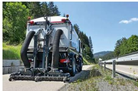
Регулировка положения при прямолинейном движении осуществляется путем поперечного смещения влево или вправо. Таким образом, задняя вакуумная тележка может быть смещена ближе к бордюру, а пневматическая подвеска обеспечивает защиту от бокового столкновения. Управление задней вакуумной тележкой осуществляется независимо от базового шасси, ее работа полностью контролируется при помощи панели управления типа ES, что гарантирует простоту и удобство эксплуатации во время движения.
