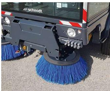
Универсальная система подметания гарантирует чистоту в любой ситуации. С лотковыми щетками буксируемого типа, установленными перед передней осью, рабочая ширина достигает 2 200 мм.
