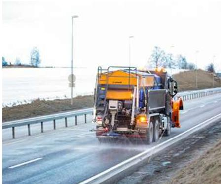
Stratos CS WSP 50K оснащен бункером объемом 5м<sup>3</sup> и системой распределения WSP.
