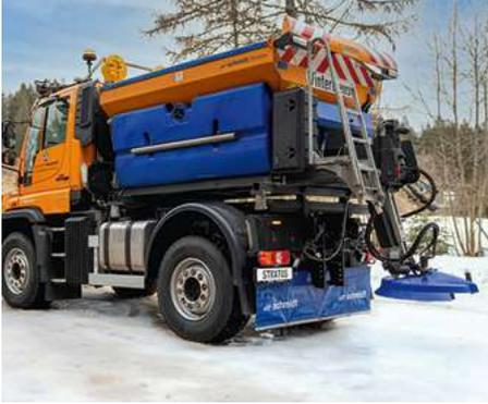
Der Stratos 25 ist eine Streumaschine mit einer Behältergrösse von 2,5 m<sup>3</sup>.
