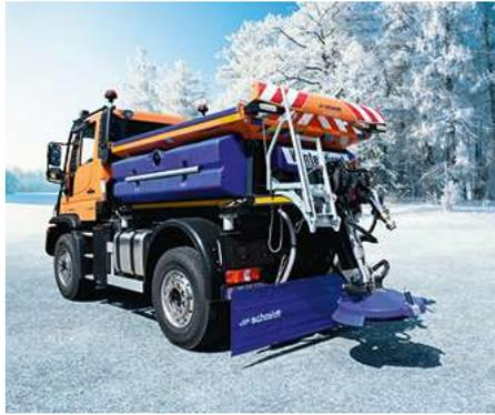
Stratos F25 - это распределитель с плоским силосом и объемом бункера 2,5 м<sup>3</sup>.
