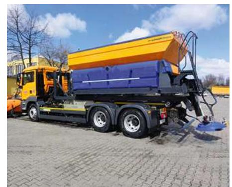
Stratos 100 är en spridare med en behållarkapacitet på 10 m<sup>3</sup>.
