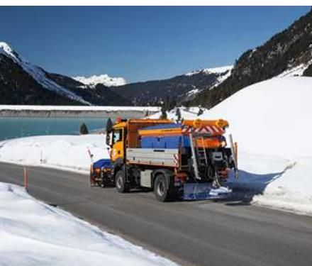
Stratos 50 är en spridare med en behållarkapacitet på 5 m<sup>3</sup>.
