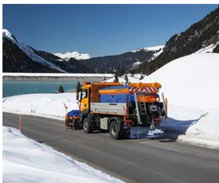
Stratos 50 er en spreder med en kapasitet på 5 m<sup>3</sup>.
