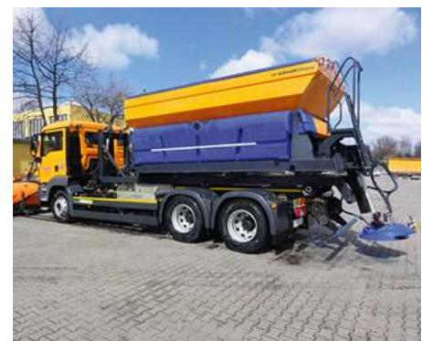
Stratos 100 er en lastebilspreder med en kapasitet på 10 m<sup>3</sup>.
