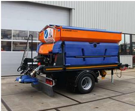
Stratos A50K - это буксируемый распределитель с объемом бункера 5 м<sup>3</sup>.
