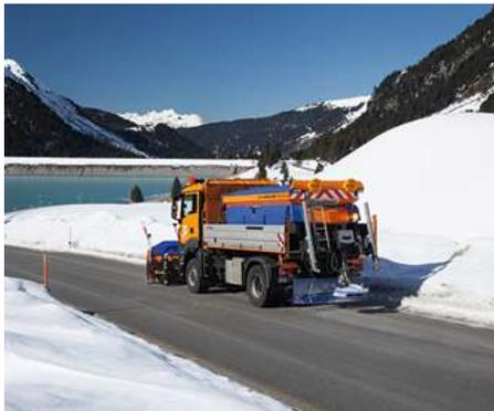
Stratos 50 - это распределитель твердых реагентов типа с емкостью бункера 5 м<sup>3</sup>.
