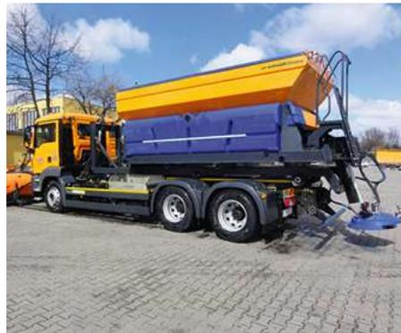
Stratos 100 - это распределитель твердых реагентов типа с емкостью бункера 10 м<sup>3</sup>.
