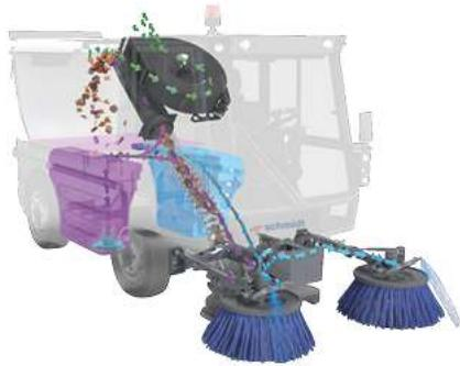
Det 2-broom systemet med uavhengig kontrollerte sirkulære børster garanterer absolutt mobilitet i alle feiende situasjoner. To stabile kost armer med integrerte buffere tillater feiende bredder på opptil 2 900 mm.
