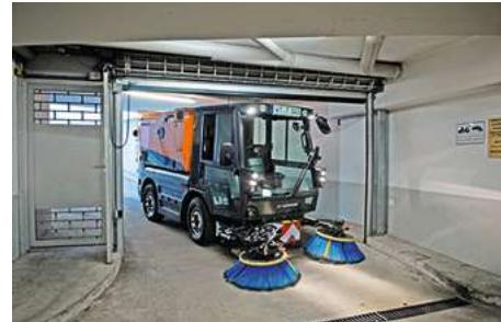
Et **lavere løpeutstyr** (valgfritt) forenkler kjøring i parkeringsplasser med flere etasjer og lave innganger. Chassiset kan senkes med ca. 70 mm ved å trykke på en knapp. Systemet nivellerer seg automatisk.
